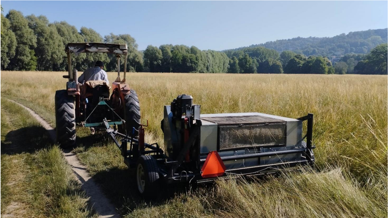
Figura 8.3: operazione di raccolta di fiorume a giugno 2022 sul sito donatore di Le Vallere (Moncalieri, TO) con macchina spazzolatrice Prairie habitats Inc. – Canada, presa in comodato d’uso dall’Institut Agricole Régional di Aosta.
