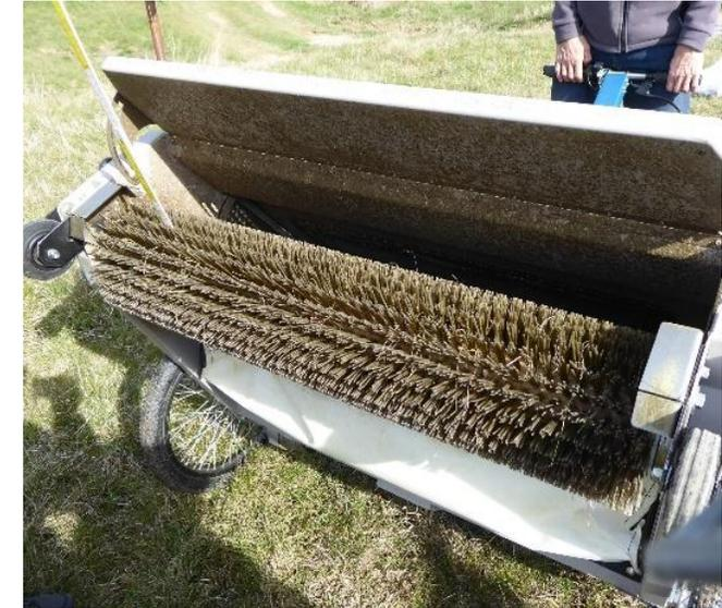
Spazzolatrice semovente eBeetle
